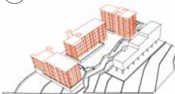
AJOUT D'UNE SUPERSTRUCTURE (TERRASSE+COURSIVE+PROTECTION SOLAIRE)
